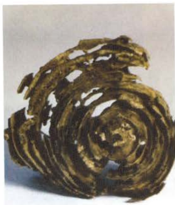
Термиты (крылатая самка, солдат, рабочая особь) Слева — часть деревянной постройки, изъеденная термитами
