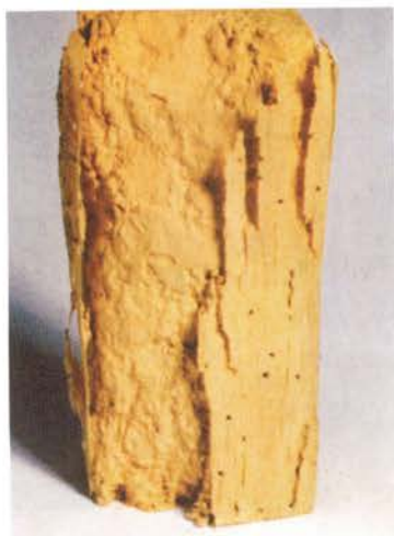
Ликтус (жук, личинка) и повреждения деревянных изделий
